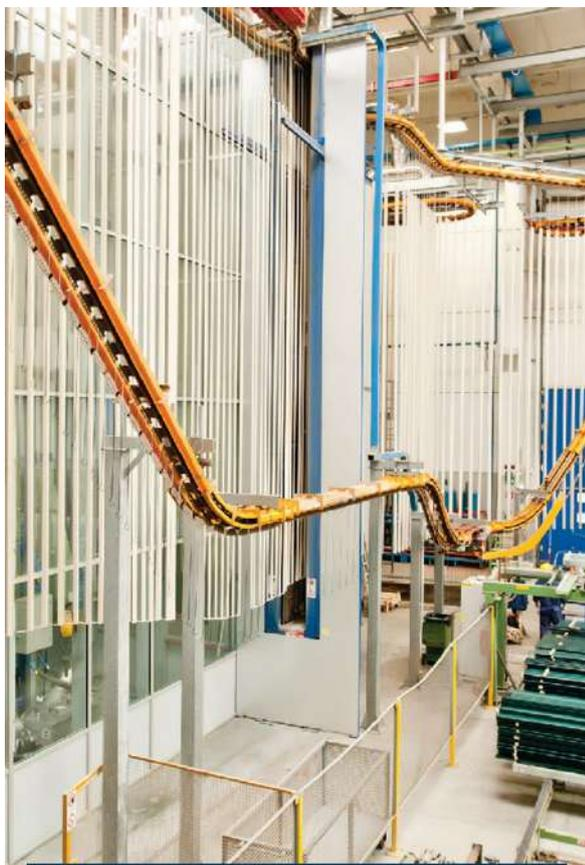
I pezzi da verniciare vengono sottoposti ad una fase di pretrattamento (sgrassatura, decapaggio e cromatazione) che protegge l'alluminio e lo rende adatto a ricevere la vernice.
