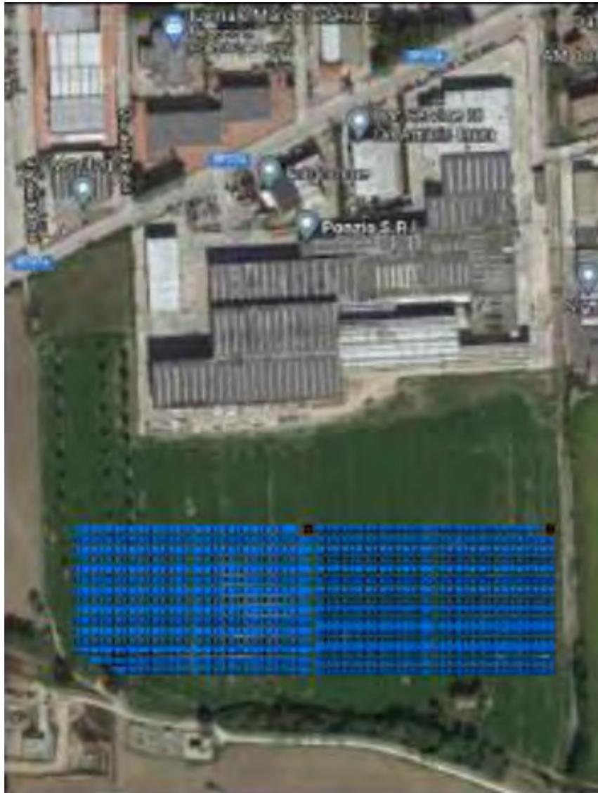
L'impianto è composto da n.8890 moduli Canadian Solar da 375 Wp cadauno, divisi in 2 sottocampi uguali della potenza di 1666,875 kWp ognuno servito da un trasformatore da 2000kVA e ricollegati in MT alla cabina principale del capannone industriale.
